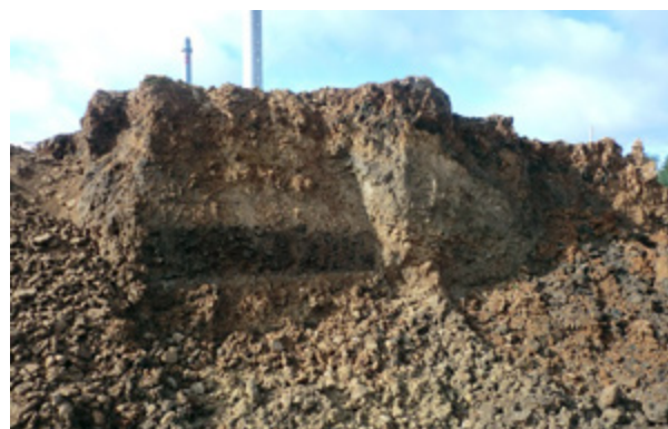
Рис. 6-4: Обработанный известковым молоком и обезвоженный осадок. Фото: Entsorgungsbetriebe Lübeck
