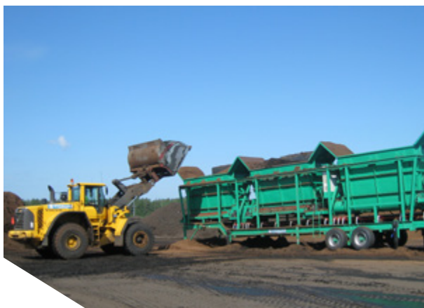
Рис. 6-6: Компостирование осадка сточных вод в Хельсинки (Финляндия) и Кохтла-Ярве (Эстония). Фото: HSY Water и OÜ Järve Biopuhustus
