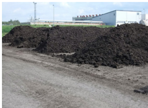
Рис. 6-6: Компостирование осадка сточных вод в Хельсинки (Финляндия) и Кохтла-Ярве (Эстония). Фото: HSY Water и OÜ Järve Biopuhustus
