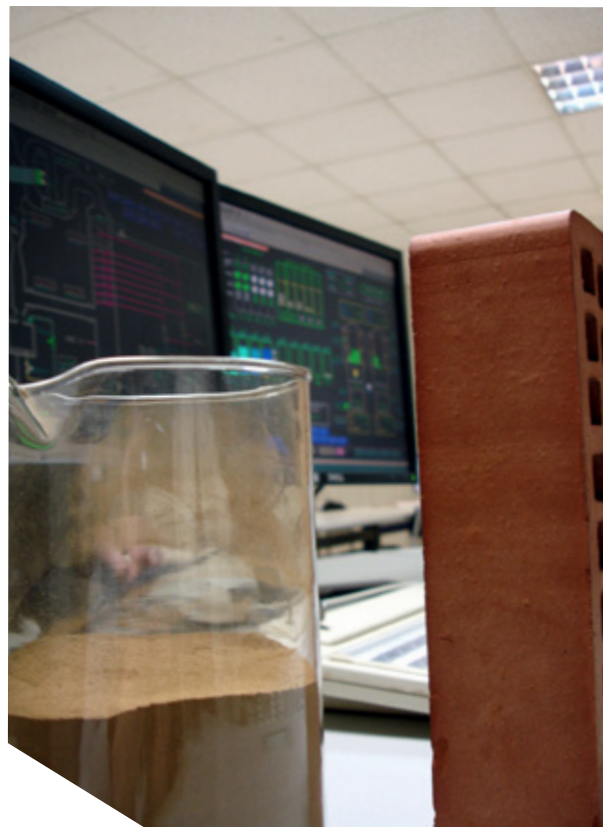
Рис. 9-3: Зола от сжигания осадка в Санкт-Петербурге (Россия) и продукция из нее. Фото: Лотта Руоканен
