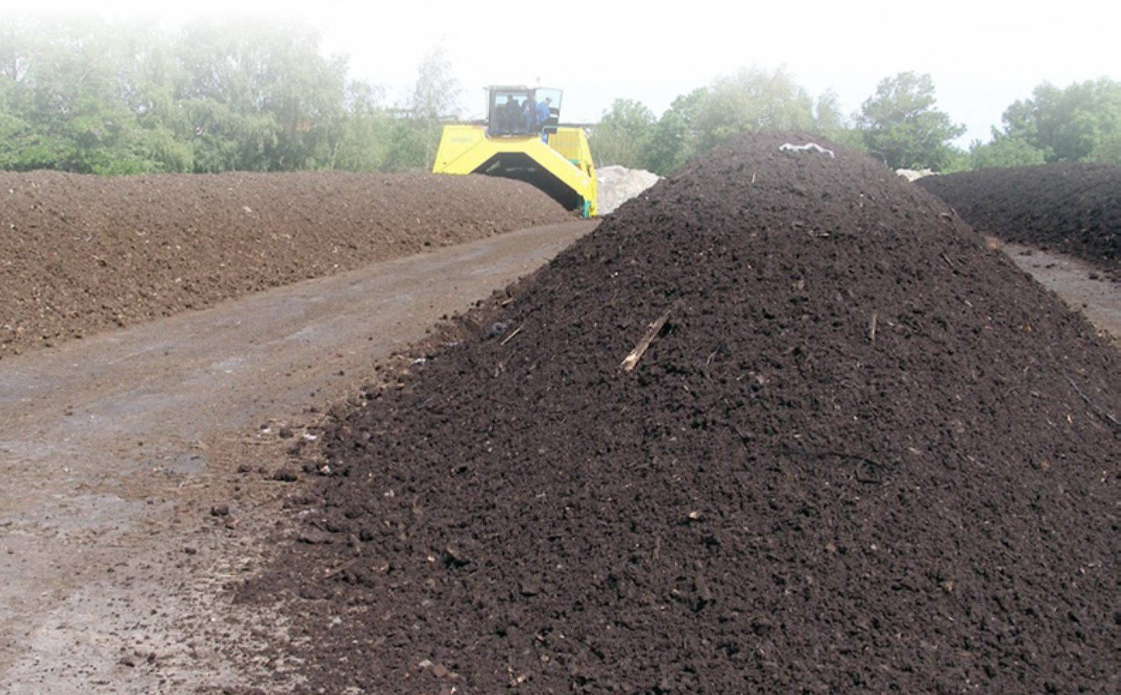
Рис. 6-8: Компостирование осадка сточных вод в Кохтла-Ярве (Эстония). Фото: OÜ Järve Biopuhastus
