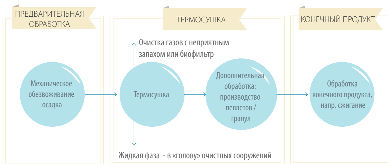
Рис. 7-1: Принципиальная схема термической сушки
