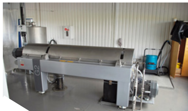
Рис. 5-3: Декантерные центрифуги в Риге и Юрмале (Латвия). Фото: SIA Rīgas ūdens и PIU Jūrmalas ūdens
