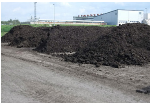
Ilustracja 6-6: Kompostowanie osadów ściekowych w Helsinkach (Finlandia) i Kohtla-Järve (Estonia). Zdjęcia: HSY Water i OÜ Järve Biopuhastus.
