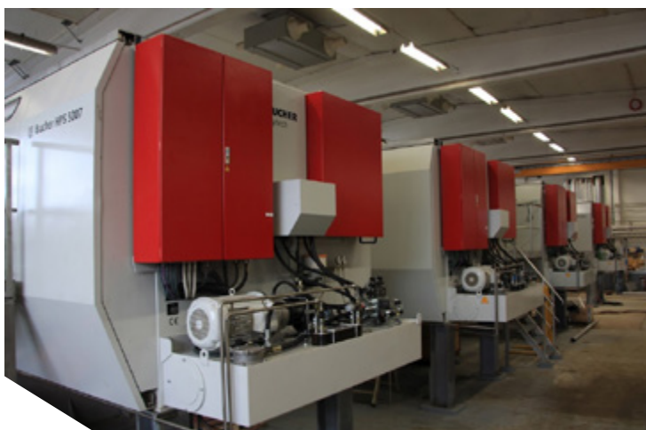
Ilustracja 5-8: Prasy hydrauliczne. Zdjęcia: Firma Bucher Unipektin AG, Szwajcaria.
