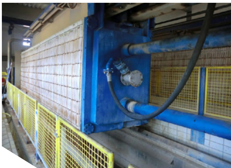
Ilustracja 5-7: Komorowa prasa filtracyjna w Lubece, Niemcy. Zdjęcie: Entsorgungsbetriebe Lübeck.
