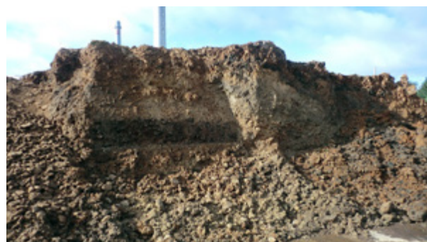
Ilustracja 6-4: Osady ściekowe kondycjonowane za pomocą mleka wapiennego, a następnie odwodnione. Zdjęcia: Entsorgungsbetriebe Lübeck.
