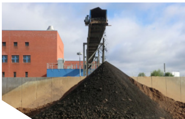
Ilustracja 6-4: Osady ściekowe kondycjonowane za pomocą mleka wapiennego, a następnie odwodnione. Zdjęcia: Entsorgungsbetriebe Lübeck.
