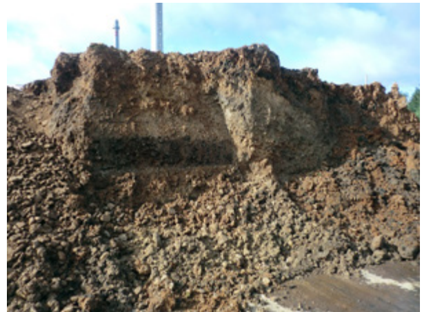
Abbildung 6-4: Klärschlamm, konditioniert mit Kalkmilch und anschließend entwässert. Fotos: Entsorgungsbetriebe Lübeck.
