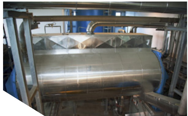
Abbildung 7-2: Scheibentrockner in Danzig, Polen. Foto: GIWK.
