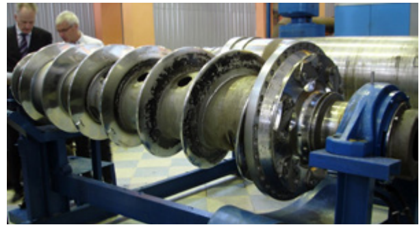
Abbildung 5-4: Zerlegte Dekanterzentrifuge in St. Petersburg, Russland. Foto: Lotta Ruokanen, HELCOM.
