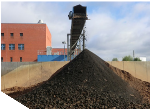
Abbildung 6-4: Klärschlamm, konditioniert mit Kalkmilch und anschließend entwässert. Fotos: Entsorgungsbetriebe Lübeck.
